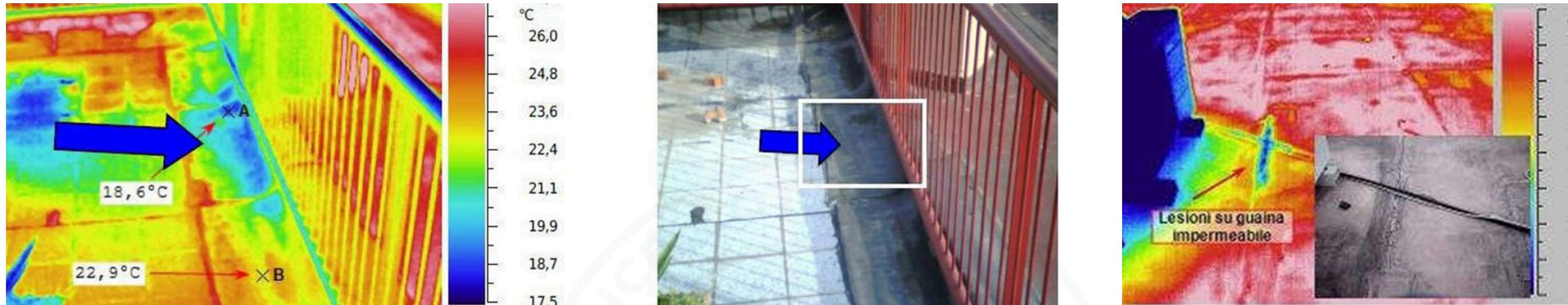
La videotermografia consente di individuare la presenza delle perdite in copertura individuando distacchi e lesioni del sistema impermeabile primario presente nella stratigrafia (guaina bituminosa, telo sintetico o rivestimento polimero cementizio continuo), **senza dover procedere con rimozioni e smantellamenti dei componenti**.
