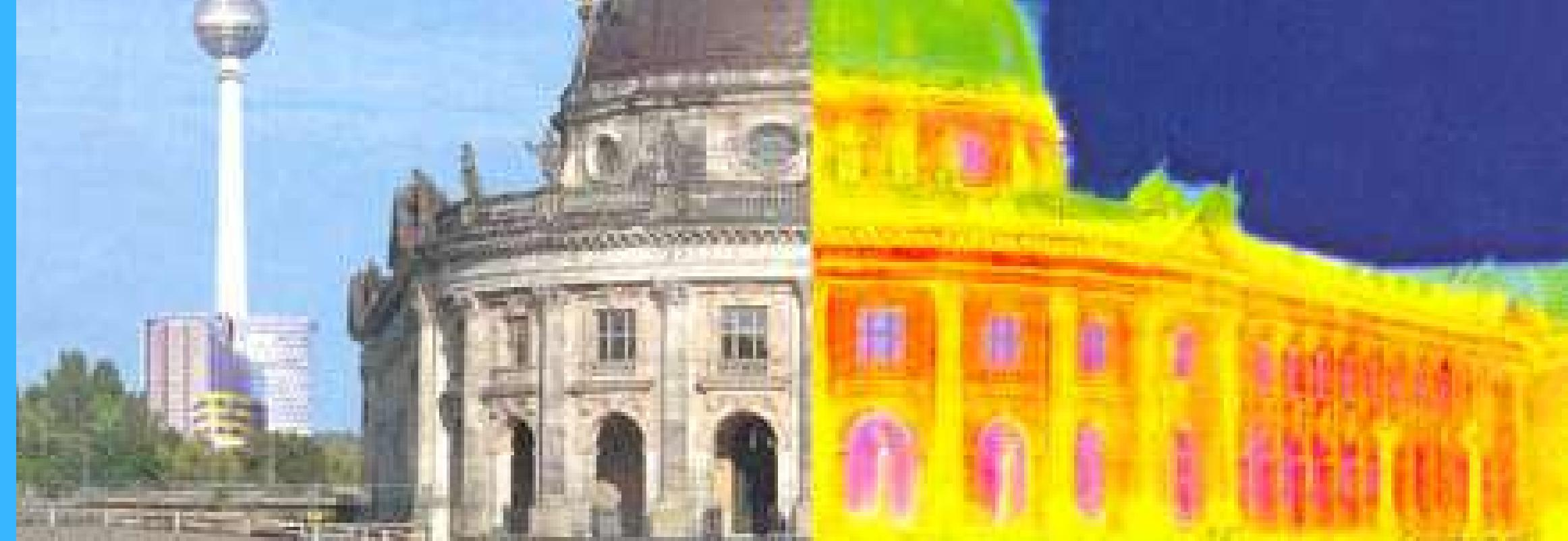
La videotermografia si basa sulla capacità di ogni corpo di emettere radiazioni termiche specifiche nel campo delle frequenze infrarosse.
