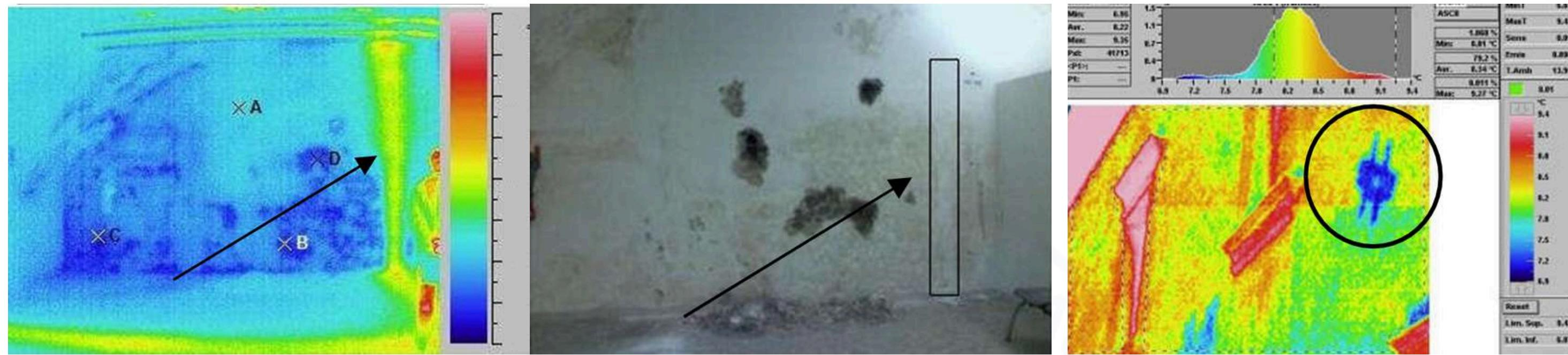
La Tecnica Video termografica a raggi infrarossi permette inoltre di verificare **la presenza di tubazioni e elementi metallici nascoste sotto il pavimento e/o all'interno della muratura.**
